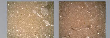
Imágenes obtenidas con microscopio óptico de transmisión de la Piedra de Boñar (Dolomías) muestras recogidas en cantera, en las proximidades de Boñar: 1. Lámina delgada sin teñir, aumento x2.5 LPNA. 2. Lámina delgada teñida, aumento x2.5 LPNA. Micrita con fósiles dolomitizada (Folk, 1959, 1962).
