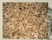
Imágenes obtenidas con microscopio óptico de transmisión, a partir de muestra recogida en la cantera del Moro. 1. Lámina delgada, aumento x2.5 LPNA. 2. Lámina delgada, aumento x2.5 LPNA. Arcosa (arenisca feldespática), constituida por cuarzo y feldespatos, con alguna biotita.
